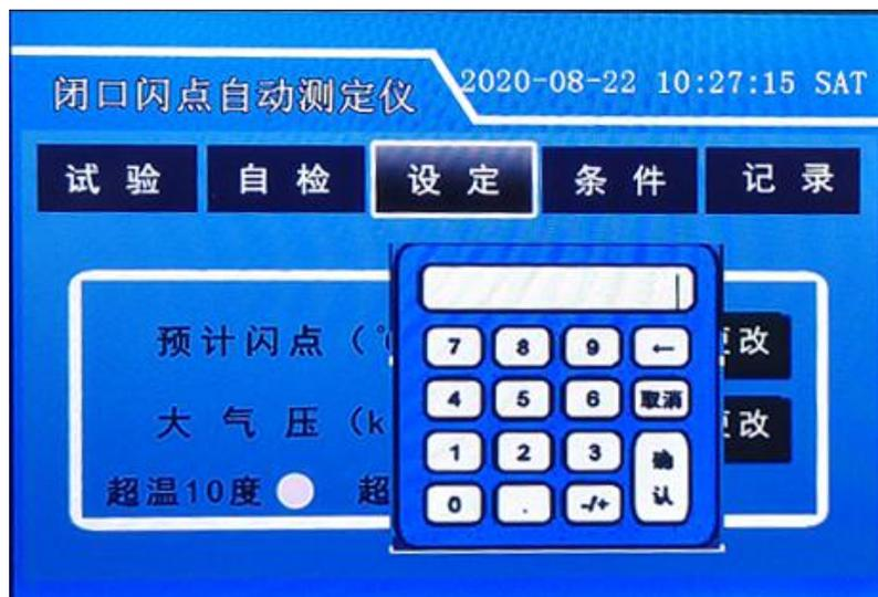
该界面下，点击“设定值”区域，键盘上方预计闪点设定值输入框处光标闪烁，可以输入数字，并按“←”确认输入。要删除输入的数字，可以点击“←”。点击右上角的“X”，退出预计闪点设定界面。
