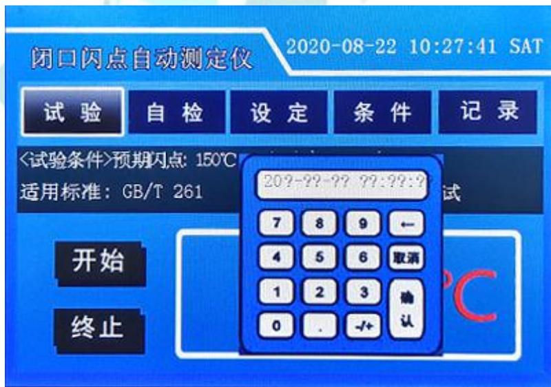
要调整日期、时间时,点击该界面上方的时间显示区域,键盘输入框中即有待修改时间显示(年、月、日、时、分、秒显示区域以“?”代替),需要按顺序逐个输入,待秒数字输入后,可点击“确定”按钮完成修改。如中途退出,请点击“取消”。
