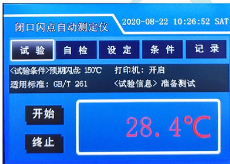
点击“开始”，测试臂落下，开始测试；点击“终止”，停止试验，测试臂升起。“试验条件”处显示测试的设定条件，包括预期闪点、打印机开关设置、试验所适用的标准等。“试验信息”处显示试验的进程信息。
