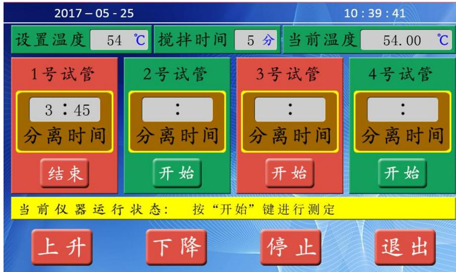
当量筒中乳化层的体积不大于 3ml 时，按“结束”，此时的分离时间即是测试结果。当分离时间到达 30 分钟后，如果乳化液没有完全分离，或乳化层没有减少为 3ml 或更少，则记录此时油层、水层和乳化层的体积。
